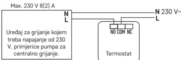
\* Prilikom priključivanja klima-uređaja na termostat, povežite fazu vodiča „L“ na priključak „NC“.
