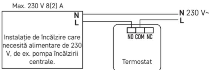
\* În cazul conectării dispozitivului de răcire la termostat, conectați conectorul de fază „L“ la borna „NC“.
