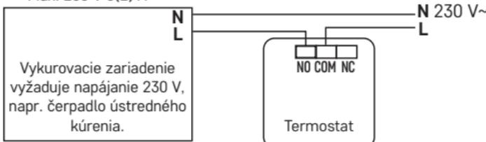
\* V prípade pripojenia chladiaceho zariadenia k termostatu pripojte fázový vodič „L“ do svorky „NC“.
