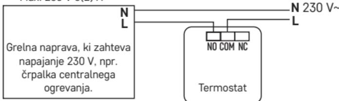
\* V primeru priključitve klimatske naprave na termostat priključite fazni vodnik „L“ v sponko „NC“.
