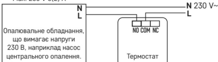
\* Якщо до термостата підключений блок охолодження, підключіть фазний провідник „L“ до клеми „NC“.
