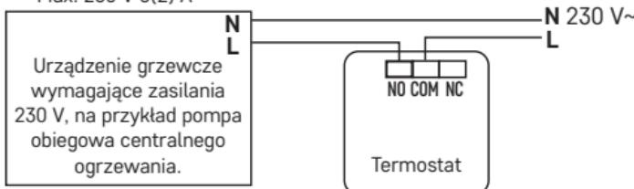
\* W przypadku podłączenia urządzenia chłodzącego do termostatu, przewód fazowy „L“ podłączamy do zacisku „NC“.
