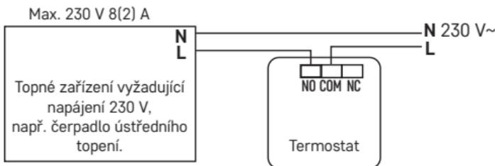
\* V případě připojení chladícího zařízení k termostatu připojte fázový vodič „L“ do svorky „NC“.
