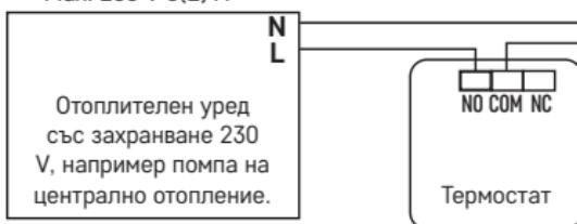
\* Когато свързвате охлаждащ уред към термостата, свържете фазовия проводник „L“ към клемата „NC“.
